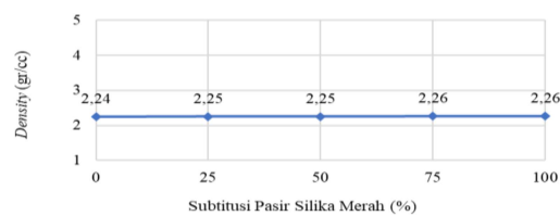
Gambar 11. Grafik Hubungan kadar Substitusi Pasir Silika Merah dengan Nilai Density
