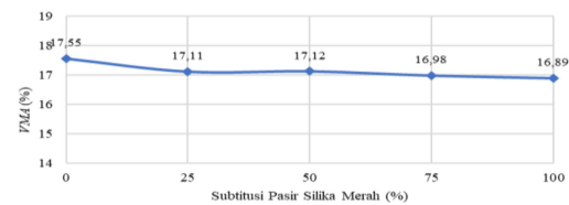
Gambar 9. Grafik Hubungan Kadar Substitusi Pasir Silika Merah dengan Nilai VMA
