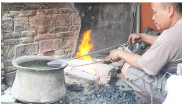
Gambar 7. Teknik Penyepuhan Pisau Besi
