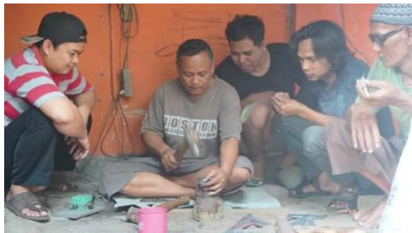
Gambar 4. Proses Penempaan Pisau Besi
