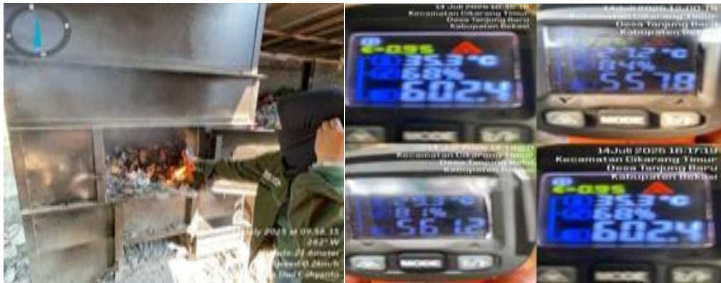
Gambar 8. Dokumentasi hasil pengujian suhu temperature insinerator tipe batch Desa Tanjung Baru Kecamatan Cikarang Timur Kabupaten Bekasi
